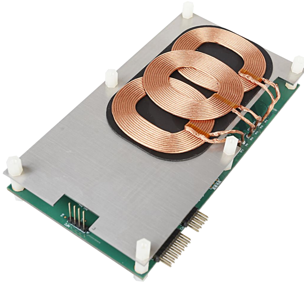
图 2.2 无线充电多线圈及屏蔽板实物图
