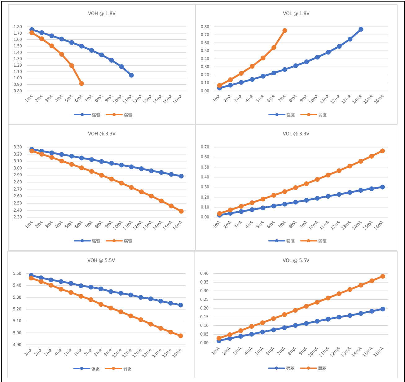
图 7-2 输出端口 VOH/VOL 实测曲线
