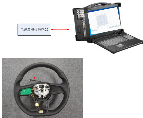
图 3.7 AS8579 DEMO 测试平台搭建
